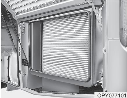
Проверьте радиатор и шланг радиатора и т.д. на предмет утечек. Проверьте, есть ли утечки охлаждающей жидкости вокруг места закрепления. Обратитесь к авторизованному дилеру HYUNDAI для проверки системы охлаждения на предмет наличия утечки.
