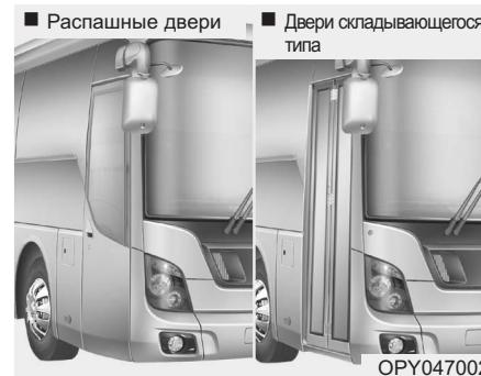
Существует два типа дверей - открывающаяся в обе стороны и складывающаяся.
