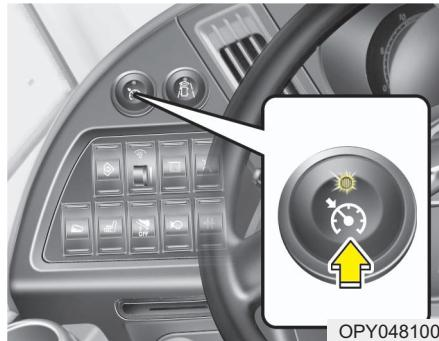
Если вы установите переключатель круиз-контроля на желаемую скорость, а затем нажмете переключатель круиз-контроля, заработает автоматическая система круиз-контроля, хотя при этом педаль газа не нажимается.
