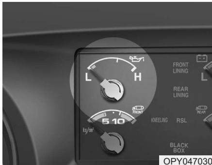
Если давление масла падает ниже 0,5 кгс/см<sup>2</sup> (50 кПа) при работе двигателя в режиме холостого хода, загорается контрольная лампа давления масла и звучит зуммер.
