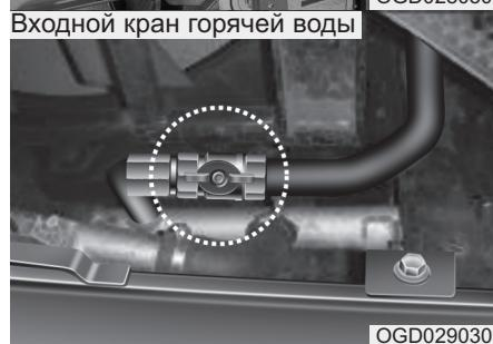
Если отопитель не используется, входной (со стороны трубы радиатора) и выходной (со стороны термостата двигателя) краны должны быть закрыты.
